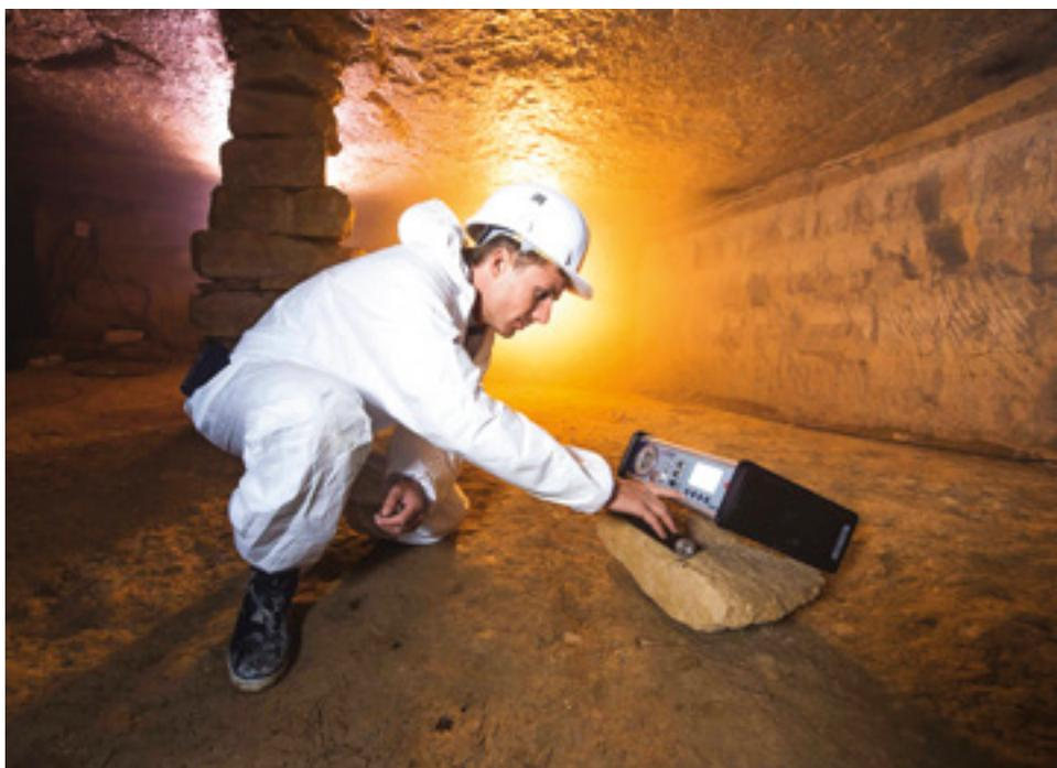
Le nouvel AlphaGUARD offre une meilleure ergonomie, une haute sensibilité, un affichage digital intégré, des modes de mesure et des fonctionnalités d'analyse additionnels. Sa large gamme d'accessoires est utilisée dans la remédiation du radon dans les bâtiments, la surveillance des rejets gazeux industriels, l'extraction d'uranium et de terres rares, les ouvrages hydrauliques, la surveillance sismique, la gestion des déchets radioactifs, etc.
