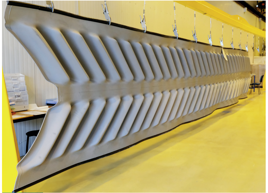
Morceau de membrane assurant l'étanchéité du nouveau sarcophage de la centrale de Tchernobyl.
