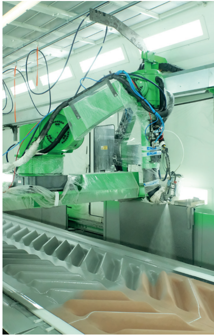
Pulvérisation robotisée de polyuréthane.
