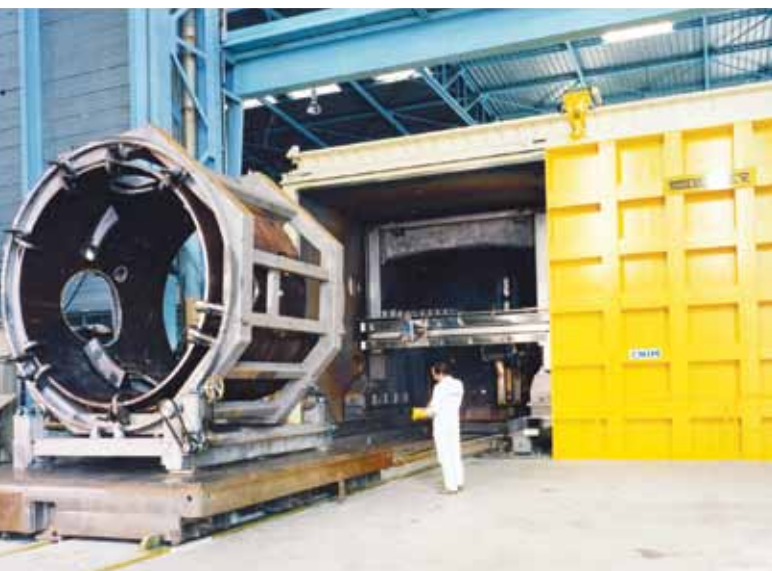
1. 3 tubes TLM M45 - 1 TLM M4 - viroille TELM SNLE-NG 2. Tube Interne Mobile M45 avant expédition
